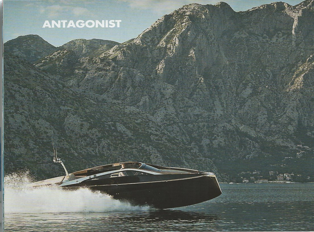
In Fahrt: Bis zu 42 Knoten erreicht die „Antagonist“ durch 550 kW von Yanmar.
