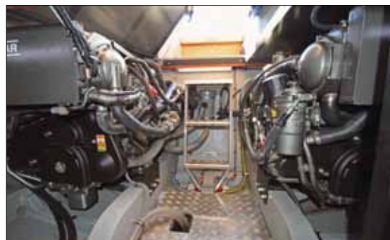
Un capot s'ouvrant électriquement laisse apparaître une spacieuse salle des machines abritant deux Yanmar de 370 chevaux.
